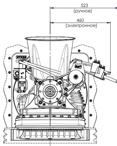
Примечание: предохранитель от перелива (расширитель смотрового окна) – дополнительная опция (на рисунке показано исполнение с установкой движителя под углом 95° к транцу). Макеты, размеры и веса движителей со стандартными водозаборными блоками с установкой под углом 90° и 95° к транцу, изображенные на рисунке выше, приведены для справки и могут быть использованы только для предварительной оценки.
